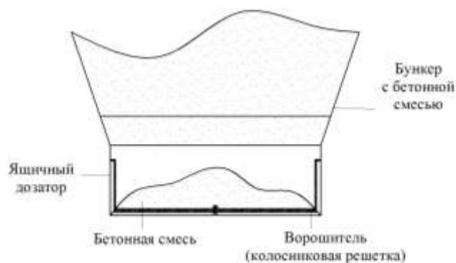
Рисунок 4.3. Равномерное распределение бетонной смеси в ящичном дозаторе
