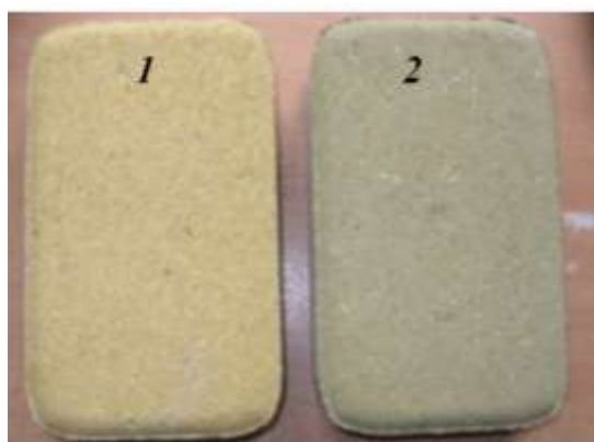
Рисунок 5.1. Влияние характерного цвета цемента при одинаковой дозировке желтого пигмента: 1 – изделие на белом цементе; 2 – изделие на сером цементе
