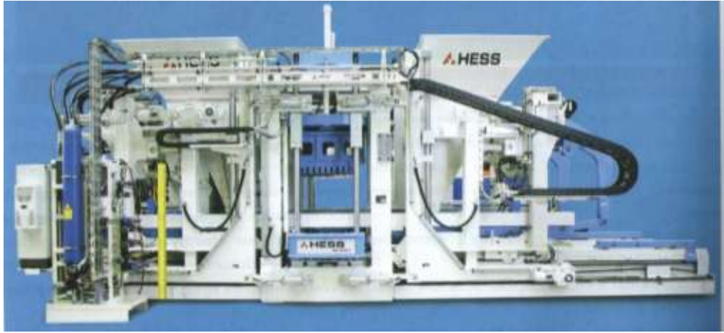
Рисунок 2.1. Вибропресс фирмы «HESS» для производства мелкоштучных изделий методом вибропрессования
