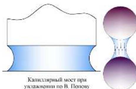
Рисунок 4.27. «Капиллярный» мост между бетоном и пуансоном
