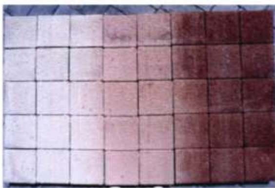
Рисунок 5.11. Плиты бетонные тротуарные, окрашенные по разработанной технологии
