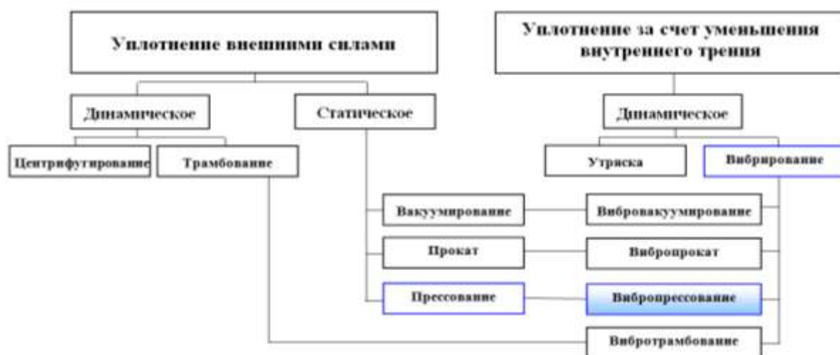
Рисунок 1.1. Способы уплотнения бетонной смеси
