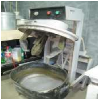
Рисунок 2.3. Смеситель лабораторный ЛС-ЦБ-10
