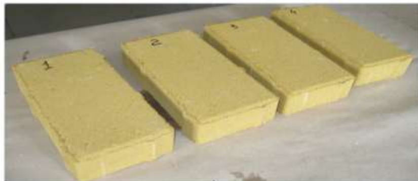
Рисунок 3.15. Образцы однослойной плиты тротуарной различного состава
