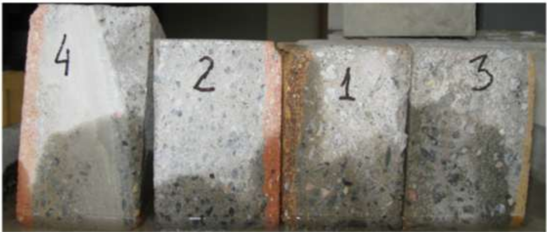
Рисунок 3.16. Высота капиллярного подъема по истечении 90 мин испытания
