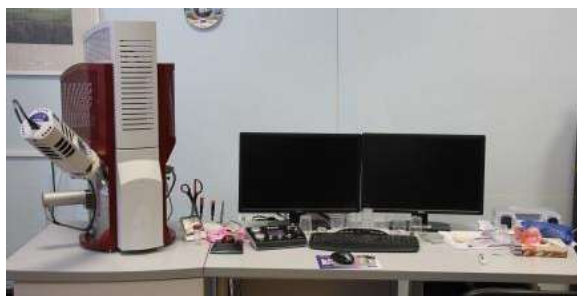
Рисунок 2.6. Сканирующий электронный микроскоп высокого разрешения TESCAN MIRA 3 LMU
