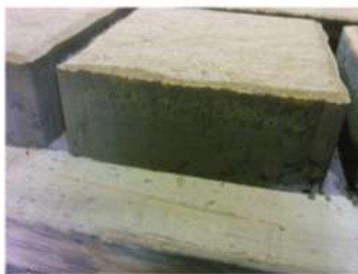
Рисунок 4.13. Дефект изделия при распалубке
